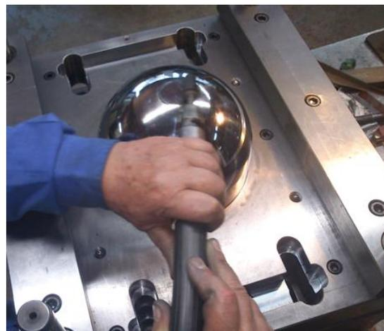
**Instalación** de resistencias flexibles.
